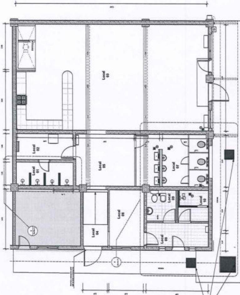
1 Planta Instalación Sanitaria Escala: 1:50
